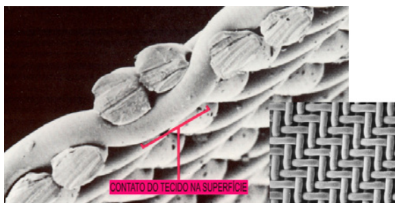
Construção 2:2 TW Sarja
