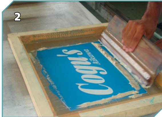
Aplicar o Sericryl Puff no lado ilegível do tecido, realizando 4 repiques com pré-cura intermediária após as impressões. Deixar secar à temperatura ambiente (25°C) por mais ou menos 1 hora.
