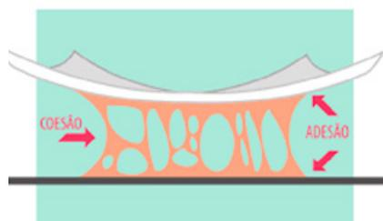
A aderência, por sua vez, refere-se à capacidade do vinil adesivo de se fixar firmemente a uma superfície — seja uma parede, um veículo ou qualquer
