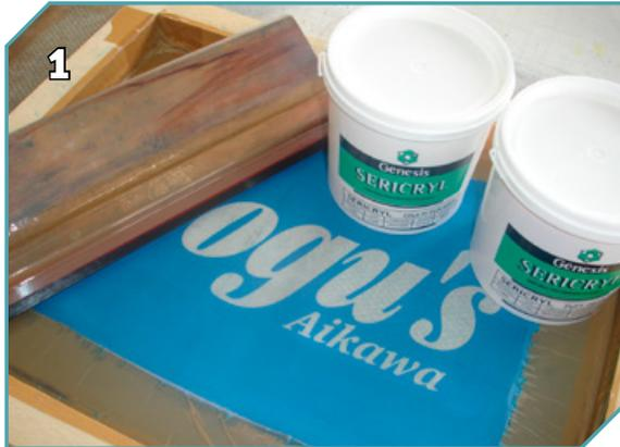
Utiliza-se 2 telas de 32 fios/cm<sup>2</sup> monofilamento. Uma com o desenho a ser dublado (de preferência sem muita definição) e outra com uma área chapada suficiente para cobrir o tamanho da estampa. As tintas são o Sericryl Puff e o Sericryl Termocolante.
