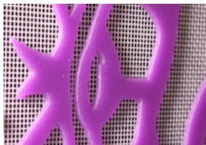
A ideia é construir um relevo adequado, independente da quantidade dos fios do tecido. Por isso uma emulsão com corpo e viscosidade adequados é importante.
