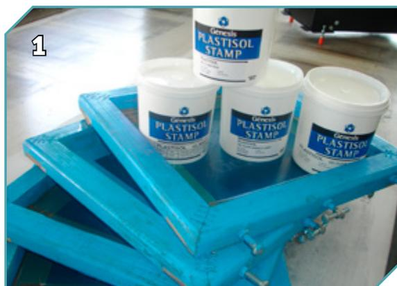
1 Utiliza-se 4 telas de 32 fios/cm<sup>2</sup> monofilamento, sendo a tela da base com leve relevo. As tintas utilizadas são o Plastisol Gel Branco, Pink Flúor, Amarelo Flúor e Azul Flúor.
