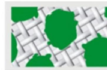
Usando a malha colorida, esse raio será colorido de acordo com a cor do tecido utilizado. Não irá sensibilizar a emulsão, deixará a gravação mais nítida nas bordas do desenho.
