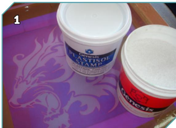
1 Utiliza-se uma tela de 32 fios/cm<sup>2</sup> monofilamento, tinta Plastisol para Jeans e pedras tipo quartzo de aquário.
