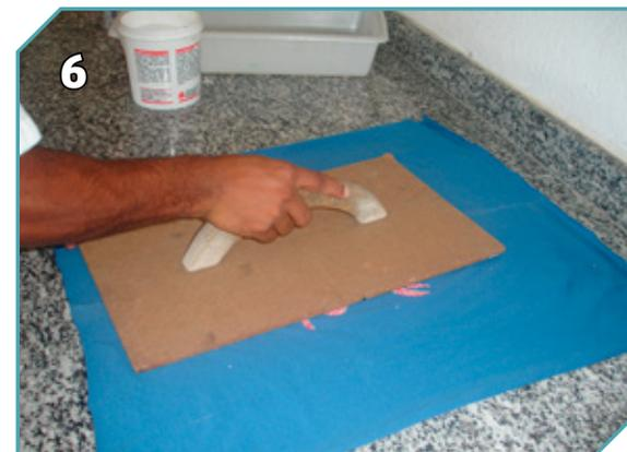
6 Utilizando uma base dura e lisa, pressionar levemente as pedras para que elas penetrem no Plastisol.
