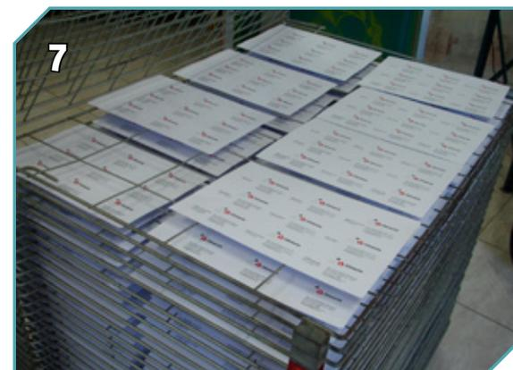
O Efeito Relevo Gráfico está pronto. Após a secagem, levar o material para corte.
