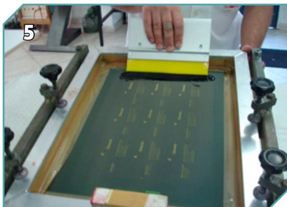
Aplicação da Seriepóxi Preto. Repetir a mesma aplicação da cor vermelha.
