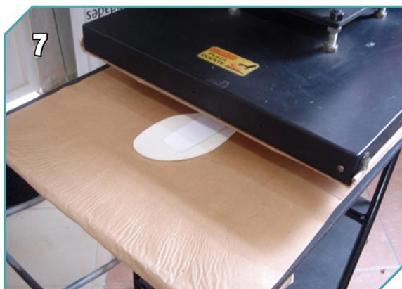
7 Colocar o papel aplicado sobre o EVA a ser transferido (na foto acima, a base de uma sandália) e levar à prensa térmica. Realizar a transferência de 110 a 120°C por 3 a 5 segundos e pressão de 50 a 80 libras.
