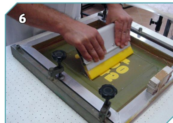
6 Aplicar o Seriplast Termocolante com a mesma tela utilizada na primeira impressão. Repicar para obter um melhor resultado.
