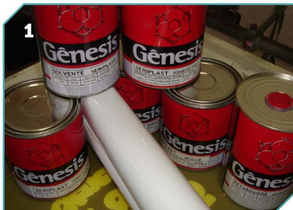
1 Para o Transfer Seriplast para EVA, utiliza-se a tinta Seriplast em diversas cores e o Papel Soft ou o Filme de Poliéster Cristal.
