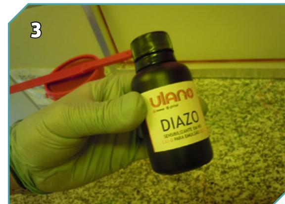
**3** Agitar bem para dissolver completamente. Aguardar 15 a 20 minutos para as espumas formadas abaixarem.
