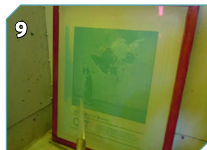
**9** Após a exposição de luz, levar imediatamente para revelar com água corrente ou jato de água com leque bem aberto.
