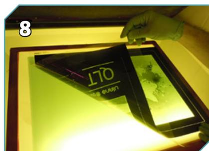
**8** Mesa de revelação: Fonte de luz única com lâmpada halógena de 1000 W. Tempo de exposição: 25 s / Fotolito: 25 Lpcm
